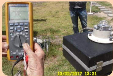
Calibración sensor de radiación en Tibaitatá
