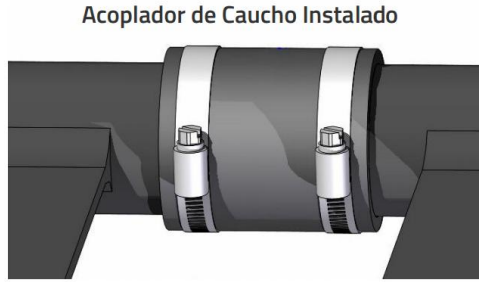
Acoplador de Caucho Instalado
