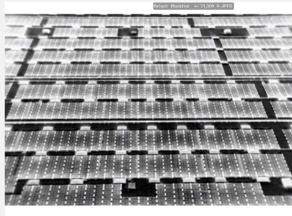
Hot Spots (Puntos calientes) son claramente visibles para facilitar un rápido mantenimiento
