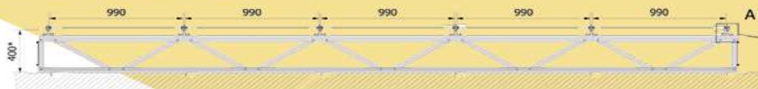
Vista lateral. Pórtico para 5 paneles.
