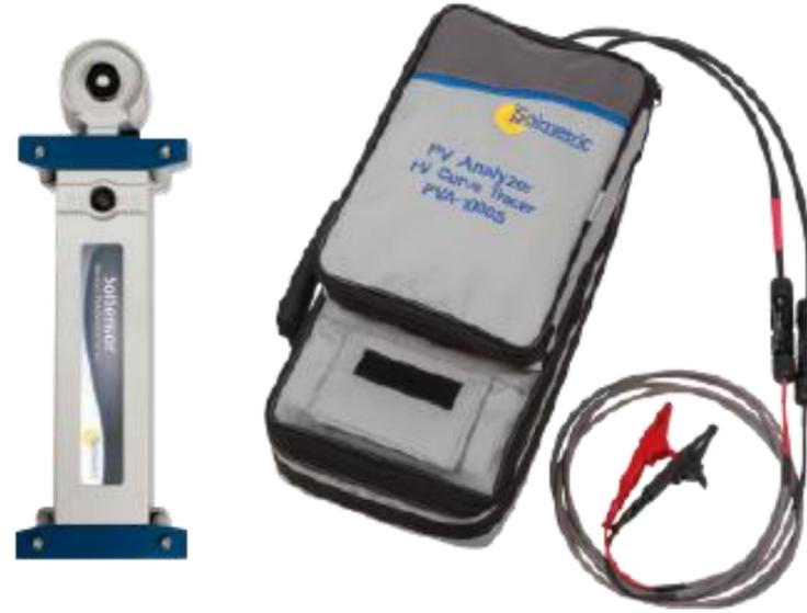
El kit analizador fotovoltaico PVA-1500V4 es un trazador de curvas I-V de 1500 voltios con modelado de rendimiento fotovoltaico incorporado y sensores inalámbricos avanzados de irradiancia, temperatura e inclinación.
