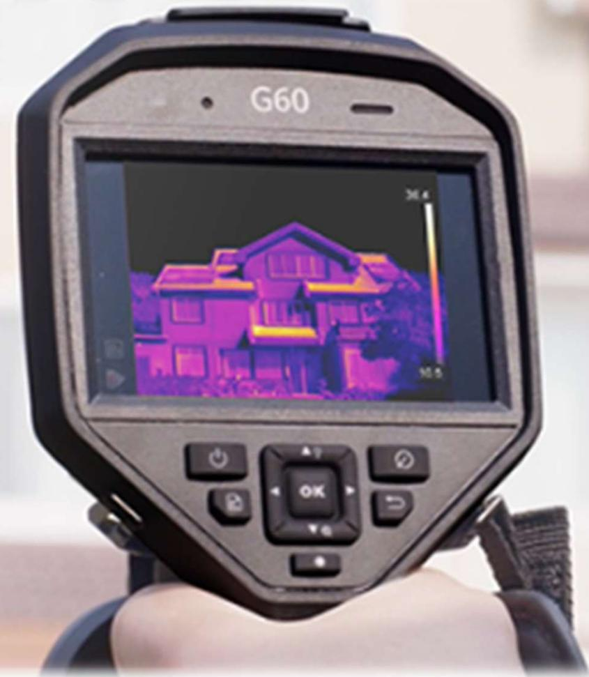
La IEC 62446 define los procedimientos de inspección de los paneles fotovoltaicos con cámara termográfica y también se indican las condiciones meteorológicas dentro de las cuales realizar las inspecciones, además de las características técnicas de las cámaras termográficas (todas las cámaras termográficas Hikmicro cumplen con las características mínimas requeridas).
