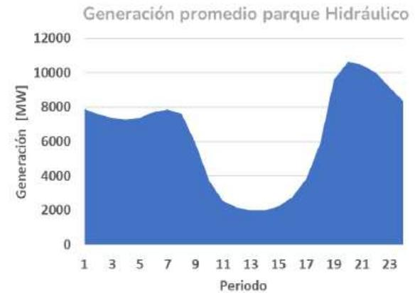
Contar con capacidad de almacenamiento hidráulico, le permite al sistema eléctrico colombiano administrar de forma eficiente la variabilidad e incertidumbre asociada a las fuentes renovables no convencionales, permitiendo el traslado de grandes bloques de energía a nivel diario, horario y entre las temporadas secas y lluviosas.
